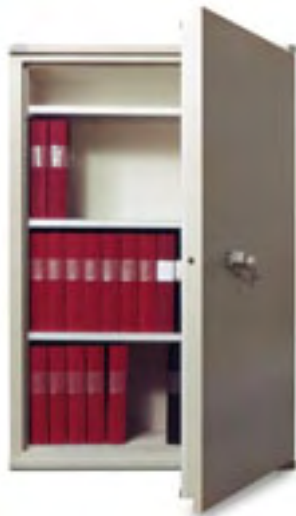
Model: 330 Mål: H1320x B885x D505 mm Indretning: 3 flytbare hylder Vægt: 300 kg Farve: Pulverlak RAL 9002 Brandklasse: 60P iht. NT Fire 017 Cylinderlås som standard
