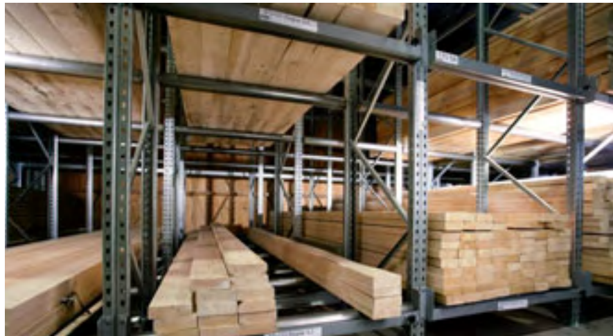
Teknisk opbygning af rullefag med låsemekanisme. Nederste indstik kan belastes med op til 4000 kg.
