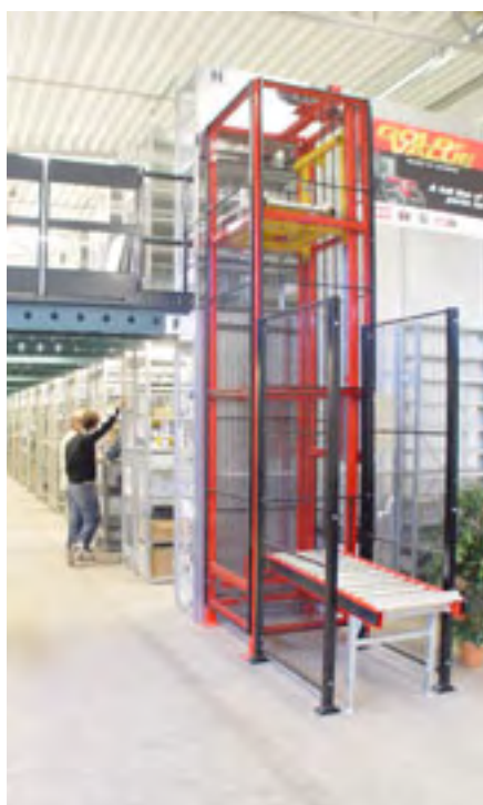
Godselevator mellem 2 mezzaninplan.
