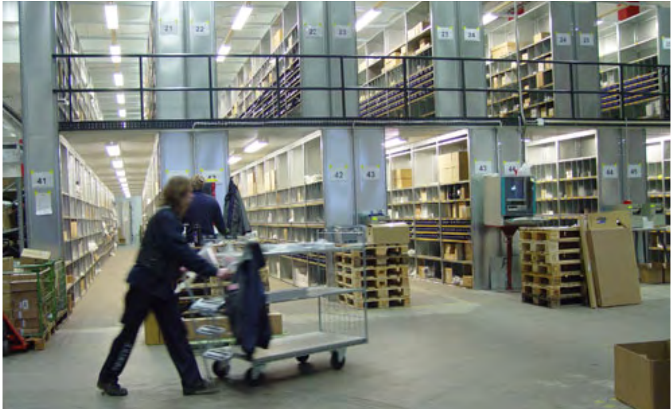
Traditionelle småvarelagre er det største marked for småvareoler. På Schenker/Nissans reservedelslager har man installeret en omfattende 2-etages mezzanin med småvareoler HI280 både i stuen og på 1. sal. Installationen rummer 9000 hyldemeter og 400 m 2 mezzaninplan.
