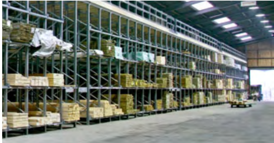
Hele indstiksreolen er 80 m lang. 2 trapper fører til mezzaninen, der har 3 palleluser.
