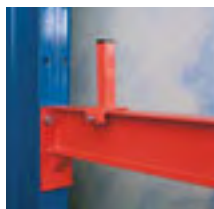
1. Opdeler Justerbar, firkantet profil 30x30 mm, findes i to højder (150 og 300 mm). Anvendes til opdeling af grenene.
