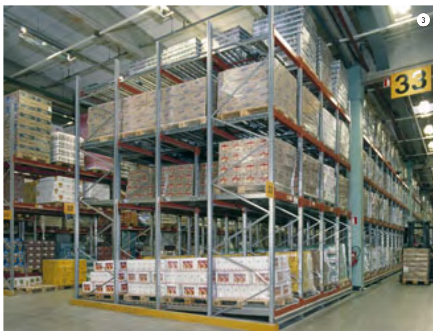
Tre-delt ud- / indløbsbane monteres, hvor der anvendes stablere eller anden truck hvor tårnet ikke kan tilte.
