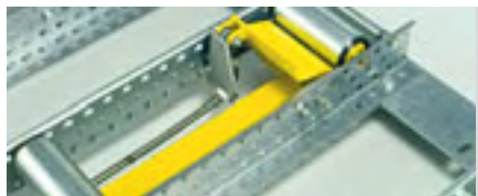
Separatører adskiller den palle, der skal hentes fra øvrige paller i banen.
